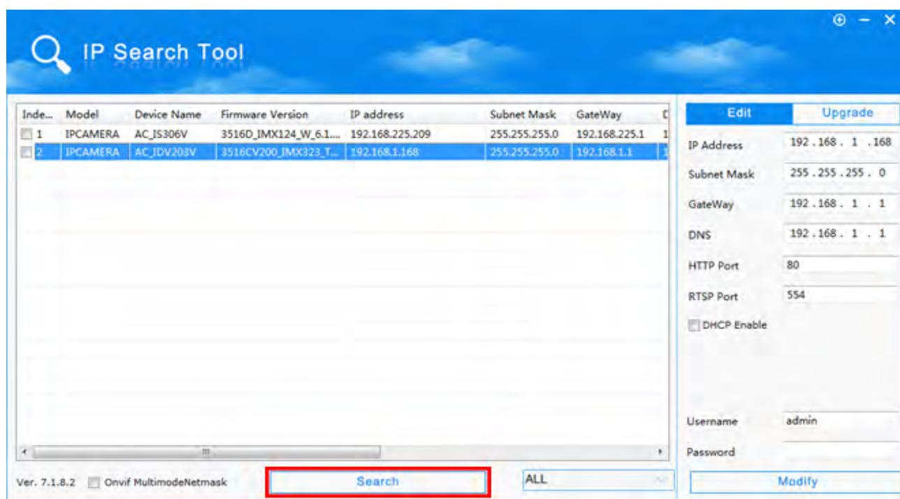
5. При первом включении камера имеет IP адрес по умолчанию. В данном случае это 192.168.1.168. Его необходимо изменить и сделать это можно двумя способами:
