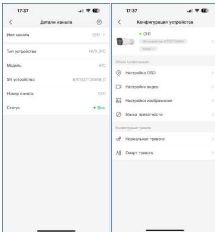
Здесь вы можете настроить имя канала, сконфигурировать выводимую на экран информацию (ввести произвольный текст, показать время, определить позицию надписи на экране). Настроить видео (выбрать основной или другой поток, тип кодирования, разрешение, частоту, битрейт и т.д.)
