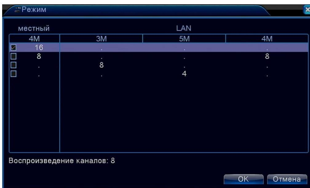
3. При выборе строки с цифровыми каналами после перезагрузки регистратора этот раздел примет вид:
