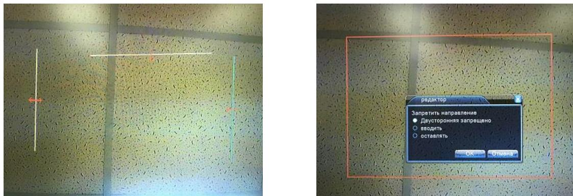
Можно задать до 8 линий пересечения или одну область (периметр). Вы можете выбрать сигнализацию о двухстороннем или одностороннем пересечении линии / периметра с указанием направления пересечения.
