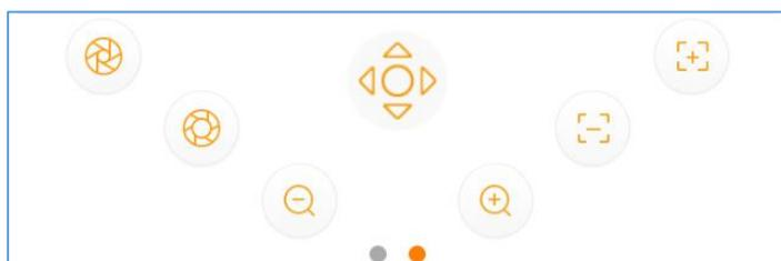
Вы имеете возможность управлять положением PTZ камеры, увеличением (Zoom), фокусом (Focus) и диафрагмой (Iris). Сделайте движение пальцем по изображению для управления движением PTZ камеры.
